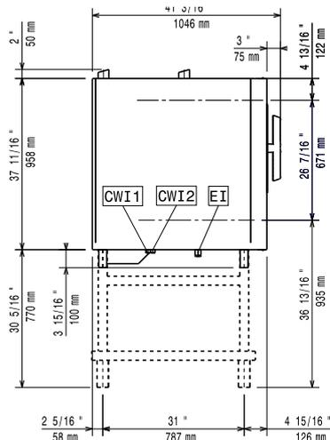
CWI1 = Raccordement eau froide      EI = Connexion électrique
